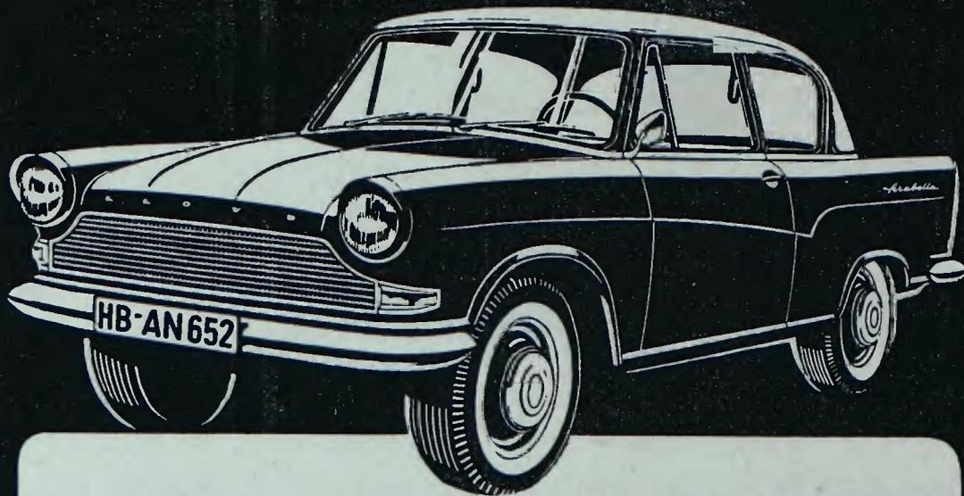
38 PS • 120 km/h • 900 ccm • 4-Zylinder • 4-Takter • Wasserkühlung • Frontantrieb
