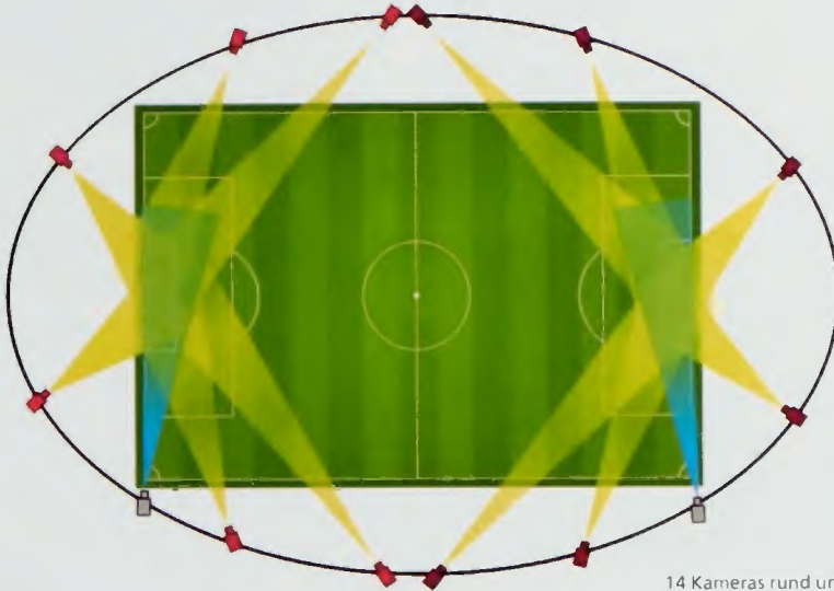
14 Kameras rund um das Spielfeld gewährleisten die absolute Funktionsfähigkeit der Torlinientechnologie
